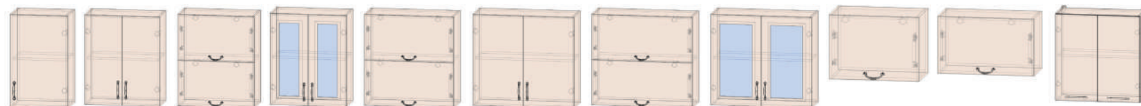
ВШ50 В720Ш500Г300 ВШ60 В720Ш600Г300 ВШ60-2дг В720Ш600Г300 ВШ60ст В720Ш700Г300 ВШ70-2дг В720Ш700Г300 ВШ80 В720Ш800Г300 ВШ80-2дг В720Ш800Г300 ВШ80ст В720Ш800Г300 ВШГ50 В360Ш500Г300 ВШГ60 В360Ш600Г300 ВШ70 В720Ш700Г300
